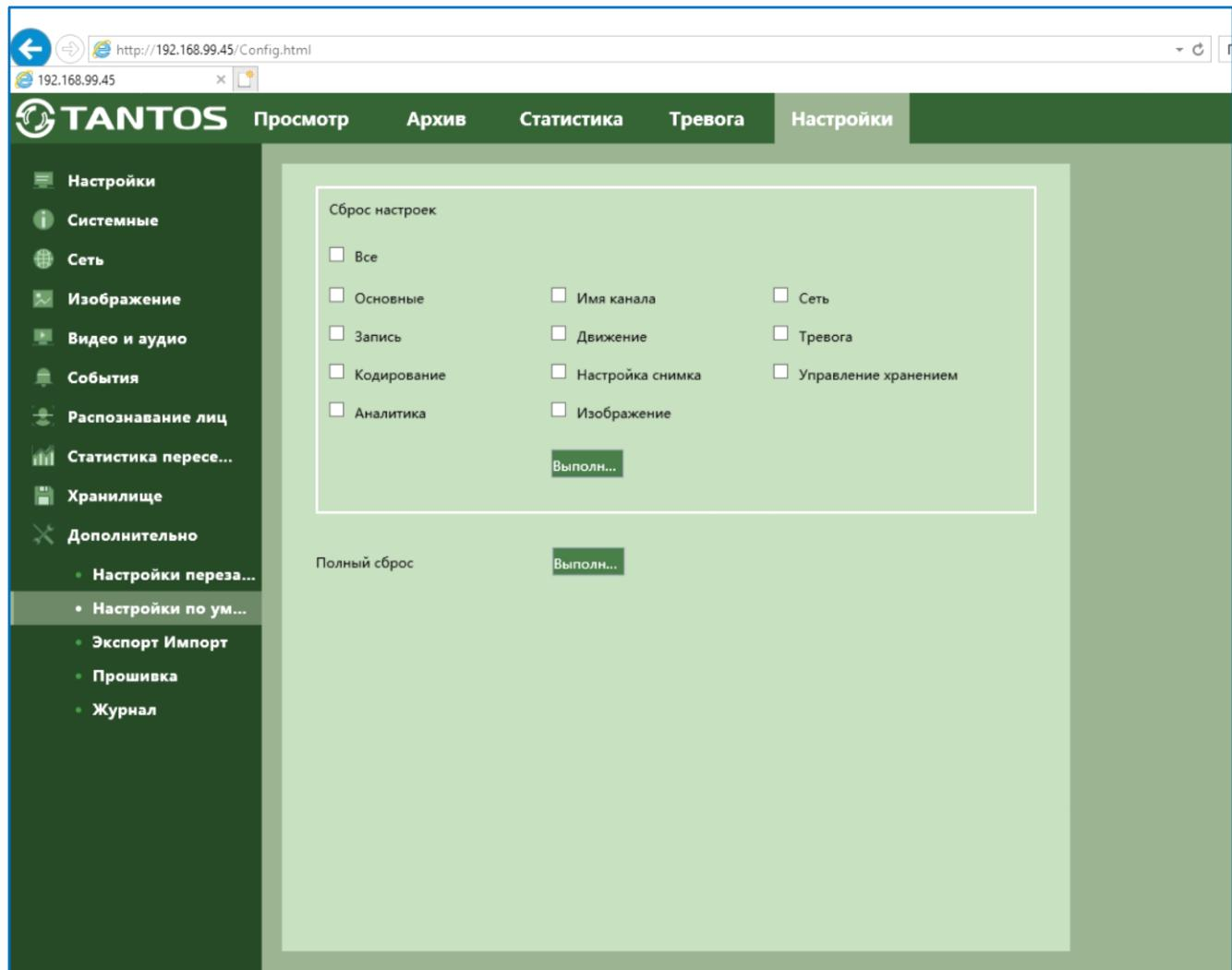
Можно вернуть к заводским установкам либо все параметры, либо часть параметров, а также выполнить полный сброс камеры.
