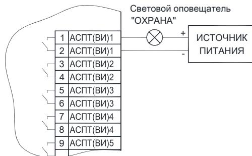
**ПРИЛОЖЕНИЕ В****СХЕМЫ ПОДКЛЮЧЕНИЯ ИЗВЕЩАТЕЛЕЙ К ПРИБОРУ «ЯХОНТ-16И»****Схема подключения извещателей ИП101 «ГРАНАТ», ИП535 «ГАРАНТ»**
