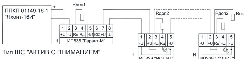
**Тип ШС "АКТИВ С ВНИМАНИЕМ"**R<sub>доп1</sub> = 1,0к ±5% (из комплекта поставки ИП535 "Гранат-М")R<sub>доп2</sub> = 2,2к ±5% (из комплекта поставки ИП329 "Иолит (-Ex)")R<sub>ок</sub> выбирается исходя из количества ИП329 "Иолит (-Ex)"R<sub>ок</sub> = 8,2к ±5% при N = 1...3R<sub>ок</sub> = 12к ±5% при N = 4...5
