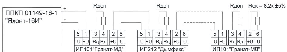
**Тип ШС "АКТИВ С ВНИМАНИЕМ"**R<sub>доп</sub> = 2,0к ±5% (из комплекта поставки извещателей)**Схема подключения извещателей ИП535 «ГАРАНТ-М», ИП329 «ИОЛИТ-Ex»**
