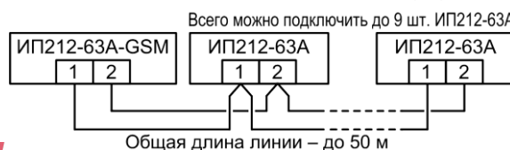
Рис.5 Схема соединения извещателей в группу с ИП212-63А-GSM
