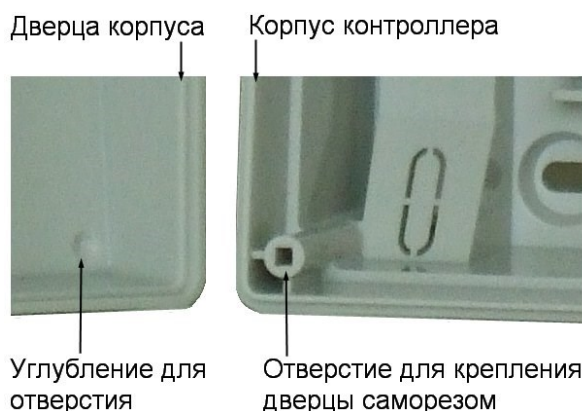
Рисунок 5. Схема «жесткого» крепления дверцы к корпусу контроллера
