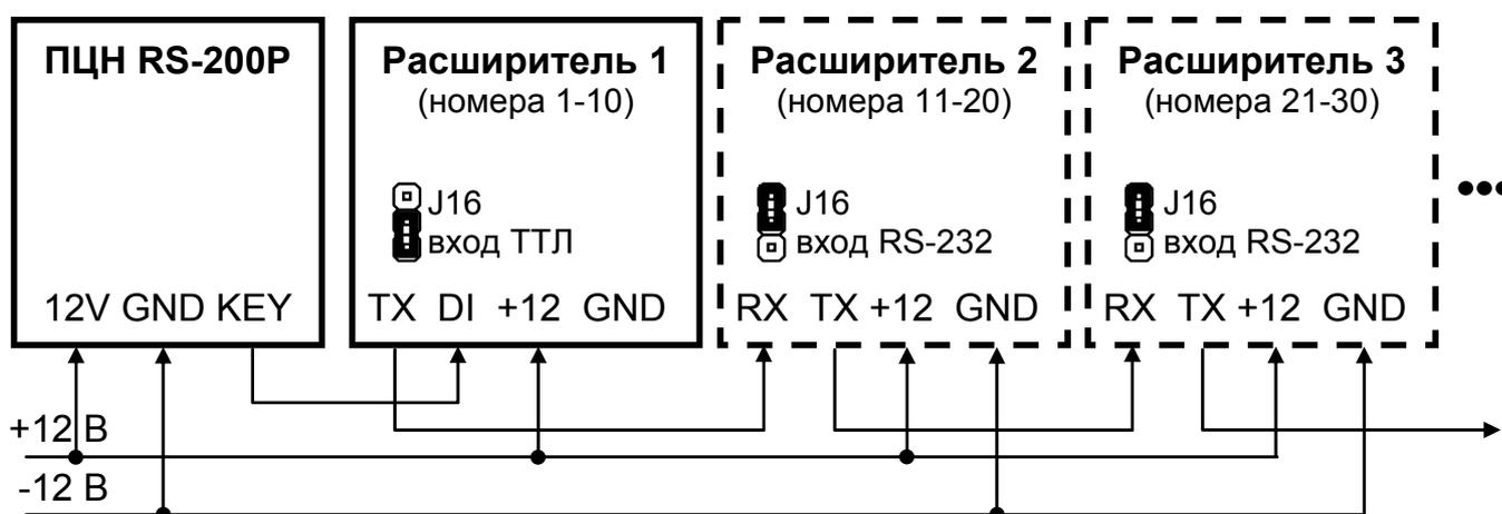
Рис. 3. Подключение расширителя к ПЦН RS-200P (до 16 шт.)
