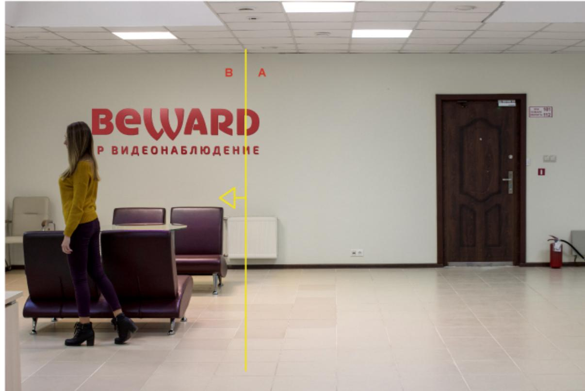
Пересечение линии реализовано, чтобы работать в большинстве внутренних и уличных условий. Тревога будет вызвана каждый раз, когда камера обнаружит пересечение определенной виртуальной линии. Функция наиболее эффективна для общего наблюдения точек входа и выхода, фиксируя объекты, пересекающие определенную виртуальную линию.
