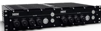
Горизонтальное соединение двух блоков и установка в стойку 19"
