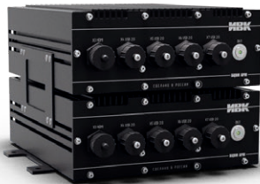
Вертикальное стекирование двух блоков
