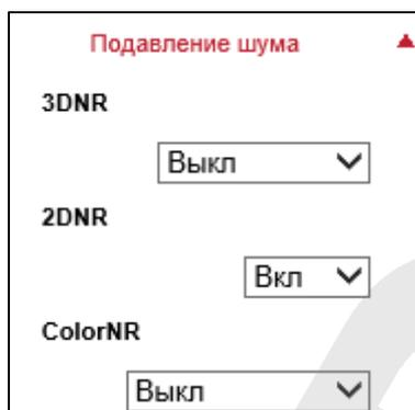
Использование данной функции позволяет снижать уровень шума при низкой освещенности. Фильтр 3DNR рассчитан для сцен со статической картинкой. Фильтр 2DNR используется для фильтрации шумов на сценах с динамической картинкой. Фильтр ColorNR используется для подавления цветowych шумов.
