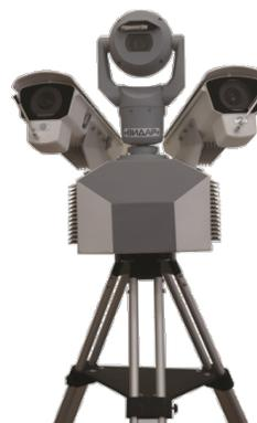
В данном комплексе используются высокочувствительные сенсоры машинного зрения сверхвысокого разрешения (20 Мп), работающие в расширенном диапазоне видимого света.
