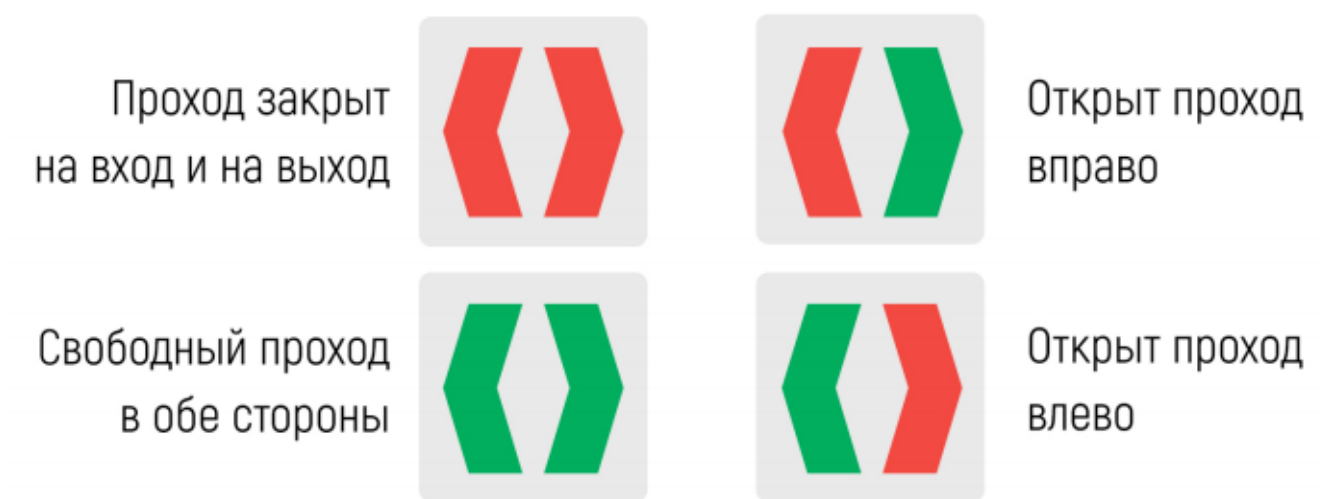
Рисунок 8 – Режимы индикации турникета
