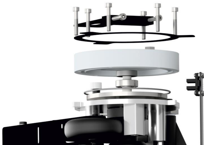
Рисунок 12.3.2 – Порядок замены сальника
