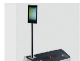
Установка терминала распознавания лиц на турникет
