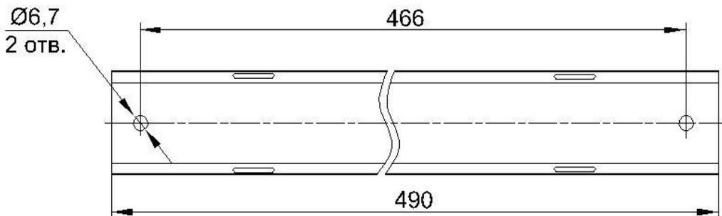
Рисунок 3 – Расположение отверстий крепления в кронштейне модуля
